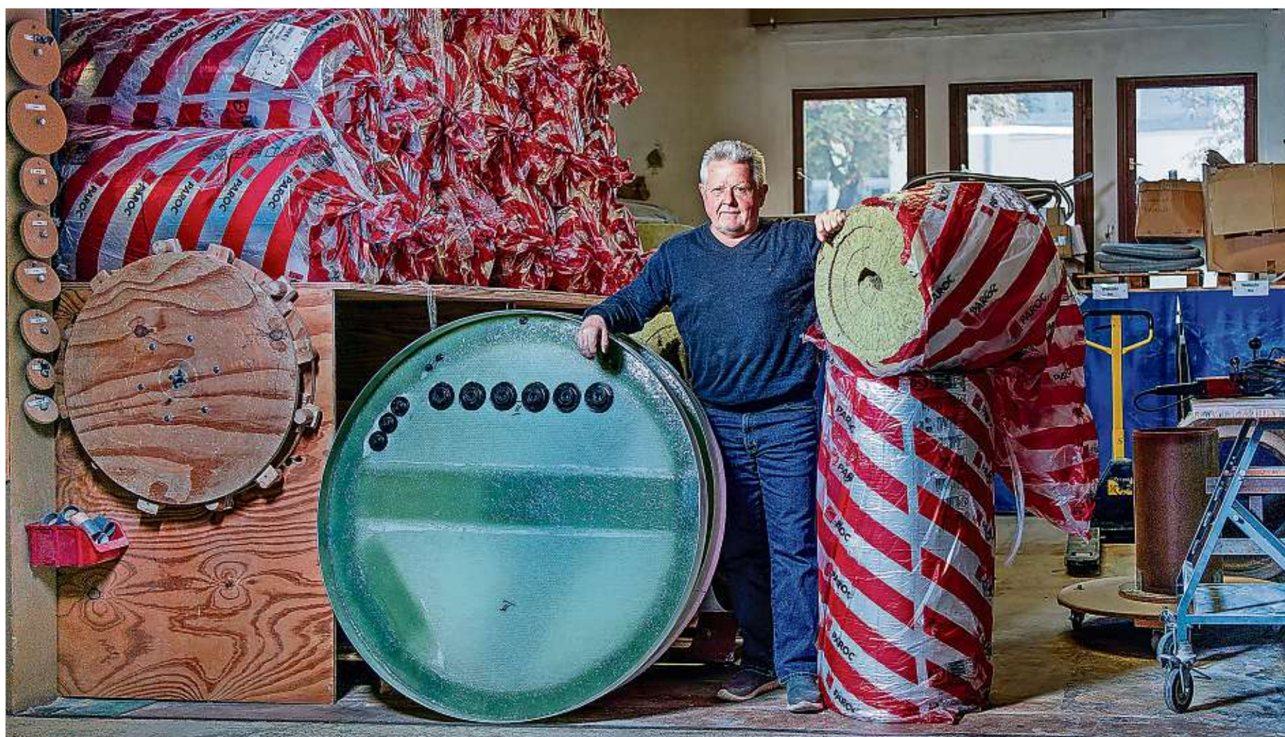
Wärmespeicher als Bausatz: Die Einzelteile des „Wärmehamsters“ von Rolf Förster werden erst im Haus montiert. So kann der „Hamster“ auch in Altbauten verbaut werden.
